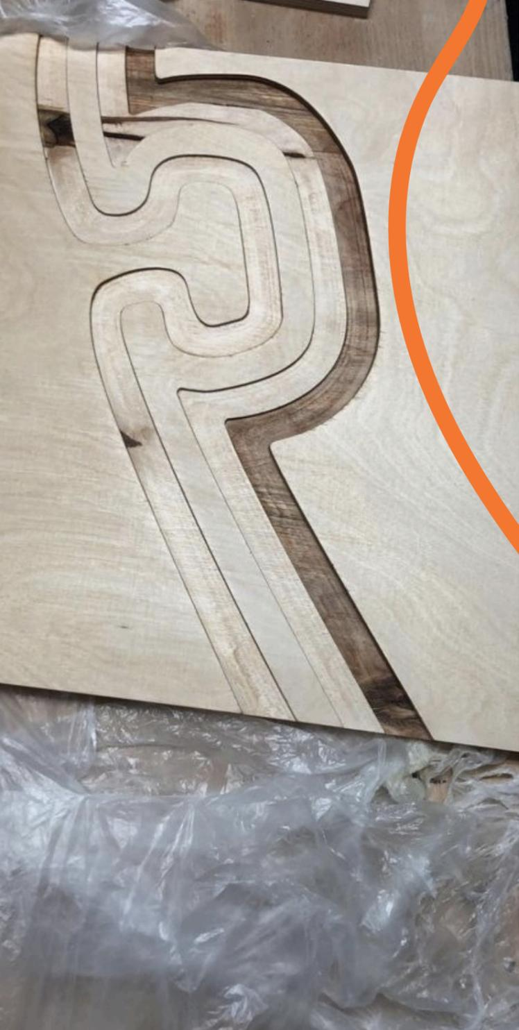
del diseño fue el cambio del ensamble principal, de tipo T, unificando lo que antes eran varios ‘dedos’ en una sola pieza ya que se detectó que a la hora de fresar podría romperse alguno de los dedos. Además, al ser una sola pieza también soportará más fuerza y tracción al manipularlo.
